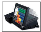
Die Hauptanzeige bzw. Bedieneranzeige ist mit einem 10,4-Zoll-LCD-Bildschirm ausgestattet. Der Betrachtungswinkel ist elektrisch einstellbar.
